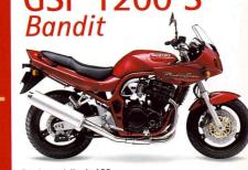
Sondermodell mit ABS 4-Zylinder, 4-Takt, luft/ölgekühlt, 1157 cm³, 72 kW/98 PS bei; 8500 min⁻¹, 90,7 Nm bei 4500 min⁻¹, DOHC, Höchst-geschwindigkeit über 200 km/h, 5 Gänge, Elektro-Starter, Sitzhöhe 840 mm, Gewicht vollgetankt 237 kg (ABS-Gewicht-244 kg), Tankinhalt (Reserve) 19 (3) Liter, Farbe: Schwarz, Rot. ABS Modelle nur Schwarz.
