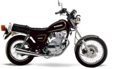
1-Zylinder, 4-Takt, luftgekühlt, 246 cm³, 13 kW/17 PS bei 8200 min⁻¹, 16,4 Nm bei 4000 min⁻¹, 0HC, Höchstge-schwindigkeit 121 km/h, 5 Gänge, Elektro-Starter, 4 Ventile, Sitzhöhe 740 mm, Gewicht vollgetankt 140 kg, Tankinhalt (Reserve) 10 (2) Liter, Farben: Rot, Schwarz.
