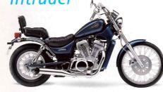
2-Zylinder, 4-Takt, luftgekühlt, 487 cm³, 33/25 kW (45/34 PS) bei 9000/7800 min⁻¹, 40/33,5 Nm bei 7400/4400 min⁻¹, DOHC, Höchstgeschwindigkeit 170/150 km/h, 6 Gänge, Elektro-Starter, Sitzhöhe 790 mm, Gewicht vollgetankt 188 kg,
