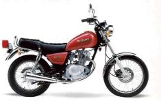
9500 min-1, 9,2 Nm bei 8500 min-1, OHC, Höchstag schwindigkeit 100 km/h, 5 Gänge, Elektro-Starter, Sitzhöhe 740 mm, Gewicht vollgetankt 112 kg, Tankinhalt (Reserve) 10 (2) Liter, Farbe: Rot.
