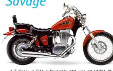
1–Zylinder, 4–Takt, luftgekühlt, 652 cm³, 23 kW/31 PS bei 5400 min¹, 45,5 Nm bei 3400 min¹, OHC, Höchstge-schwindigkeit 140 km/h, 5 Gänge, Elektro-Starter, Sitzhöhe 700 mm, Gewicht vollgetankt 171 kg, Tankinhalt (Reserve) 11 (2) Liter, Farben: Schwarz, Orange.
