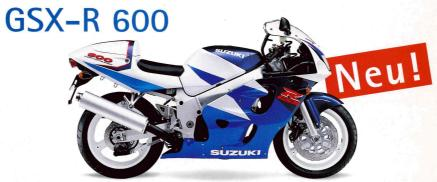
4–Zylinder, 4–Takt, Reihenmotor, flüsigkeitsgekühlt, 600 cm³, 72 kW/98 PS bei 12000 min¹, 62 Nm bei 10000 min¹, DOHC, Höchstgeschwindigkeit über 200 km/h, 6 Gänge, Elektro-Starter, 4 Ventile pro Zylinder, Sitzhöhe 830 mm, Gewicht vollgetankt 199 kg, Tankinhalt 18 Liter, Farben: Rot/Schwarz, Blau/Weiss, Blau/Schwarz.
