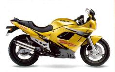
4–Zylinder, 4–Takt, luft/ölgékühlt, 600 cm³, 63/37/25 kW (86/50/34 PS) bei 11000/8600/7000 min⁻¹, 58/46,8, 40,6 Nm bei 10000/ 7000/5200 min⁻¹, DOHC, Höchstgeschwindigkeit über 200/180/160 km/h, 6 Gänge, Elektro-Starter, Sitzhöhe 795 mm, Gewicht vollgetankt 222 kg, Tankinhalt (Reserve) 20 (5) Liter, Farben: Rot/Schwarz, Gold.
