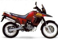
1-Zylinder, 4-Takt, luft/ölgekühlt, 779 cm³, 37/25 kW (50/34 PS) bei 6600/6000 min¬¹, 59/57,5 Nm bei 5400/2800 min¬¹, OHC, Höchstgeschwindigkeit 160/135 km/h, 5 Gänge, Elektro-Starter, 4 Ventile, Sitzhöhe 890 mm, Gewicht vollgetankt 225 kg, Tankinhalt (Reserve) 24 (4) Liter, Farben: Schwarz, Maroon.
