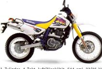
1-Zylinder, 4-Takt, luft/ölgekühlt, 644 cm³, 32/25 kW (44/34 PS) bei 6400/6000 min³, 53,9/46,3 Nm bei 4600/4000 min³, OHC, Höchstgeschwindigkeit 150/140 km/h, 5 Gänge, Sitzhöhe 890/850 mm, Gewicht vollgetankt 165 kg
