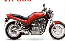
2-Zylinder, 4-Takt, 45°-V-Motor, wassergekühlt, 805 cm³, 44/25 kW (60/34 PS) bei 6800/6000 min¹, 69,0/61,1 Nm bei 5400/3200 min¹, OHC, Höchstgeschwindigkeit 175/150 km/h, 5 Gänge, Elektro-Starter, Kardanantrieb, Sitzhöhe 785 mm, Gewicht vollgetankt 240 kg, Tankinhalt (Reserve) 19 (3), Farben: Schwarz/Maroon.
