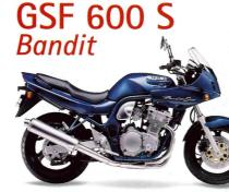
4–Zylinder, 4–Takt, luft/ölgekühlt, 600 cm³, 57/25 kW (78/34 PS), 54,1/43,4 Nm bei 9500/4300 min¹, DOHC, Höchstgeschwindigkeit 200/150 km/h, 6 Gänge, Elektro-Starter, Sitzhöhe: 820 mm, Gewicht vollgetankt 219 kg, Tankinhalt (Reserve) 19 (4) Liter, Farben: Schwarz, Rot, Grün.
