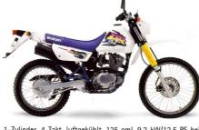
1–Zylinder, 4–Takt, luftgekühlt, 125 cm³, 9,2 kW/12,5 PS bei 9800min $^{-1}$ , 9,0 Nm bei 8600 min $^{-1}$ , 0HC, Höchstgeschwindigkeit 95 km/h, Elektro-Starter, Sitzhöhe 840 mm, Gewicht vollgetankt 127 kg, Tankinhalt (Reserve) 13 (2,5) Liter, Farbe: Weiss/Blau.
