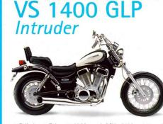
2-Zylinder, 4-Takt, 45°-V-Motor, luft/ölgekühlt, 1360 cm³, 45 kW/61 PS bei 5000 min⁻¹, 105 Nm bei 2800 min⁻¹, OHC, Höchstgeschwindigkeit 170 km/h, 5 Gänge, Elektro-Starter, Kardanantrieb, Sitzhöhe 740 mm, Gewicht Vollgetankt 260 kg, Tankinhalt (Reserve) 13 (3) Liter, Farben: Schwarz, Blau, Maroon.
