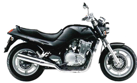
GSX 1100 G 4-Zylinder, 4-Takt, Reihenmotor, Luft/Ölgekühlt, 1128 cm 3 , 74 kW bei 8000 min -1 , 98 Nm bei 7000 min -1 , DOHC, 4 Ventile pro Zyl., 4 in 2 Auspuff-Anlage, 5 Gänge, Kardan-Antrieb, über 200 km/h, Sitzhöhe: 790 mm, Tankinhalt (Reserve) 21 (5) Liter, Farben: Schwarz, Gold.
