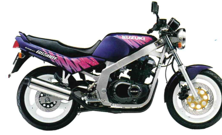
GS 500 E 2-Zylinder, 4-Takt, luftgekühlt, 487 cm 3 , 34/20 kW bei 9200/8000 min -1 , 39/29 Nm bei 7800/4500 min -1 , DOHC, 2 Ventile pro Zylinder, 6 Gänge, 175/135 km/h, vollgetankt 188 kg, Sitzhöhe: 790 mm, Tankinhalt (Reserve) 17 (3) Liter, Farben: Rot, Schwarz, Purple.
