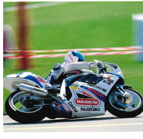
GSX 1100 F 4 Zylinder, 4-Takt, Reihenmotor, Luft/Ölgekühlt, 1128 cm 3 , 74 kW bei 8000 min -1 , 96 Nm bei 6500 min -1 , DOHC, 4 Ventile, 5 Gänge, über 200 km/h, Gewicht vollgetankt 273 kg, Sitzhöhe: 795 mm, Tankinhalt (Reserve) 21 (7) Liter, Höhenverstellbare Scheibe, Farben: Rot, Purple-Silber.
