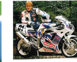
GSX 750 F 4-Zylinder, 4-Takt, Reihenmotor, Luft/Ölgekühlt, 748 cm 3 , 74 kW bei 10400 min -1 , 70,6 Nm bei 9800 min -1 , DOHC, 4 Ventile pro Zyl., 6 Gänge, über 200 km/h, vollgetankt 231 kg, Sitzhöhe: 800 mm, Tankinhalt (Reserve) 20 (5) Liter, Farben: Schwarz, Rot, Silber.
