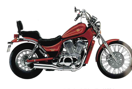
VS 800 2-Zylinder, 4-Takt, 45°-V-Motor, wassergekühlt, 805 cm 3 , 37 kW bei 6400 min -1 , 63 Nm bei 4000 min -1 , OHC, 5 Gänge, 160 km/h, Kardan-Antrieb, vollgetankt 216 kg, Sitzhöhe: 755 mm, Tankinh. (Reserve) 12 (3) Liter, in Deutschland ohne Soziallehne, Farben: Blau, Rot.
