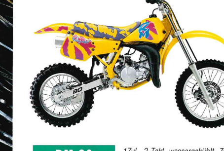
RM 125 12yl., 2-Takt, wassergekühlt, 124,8 cm 3 , 28,3 kW bei 11 000 min -1 , 25,9 Nm bei 9500 min -1 , Bohrung x Hub: 54 x 54,5 mm, 6 Gänge, Tankinhalt 7,8 Liter, Wettbewerbsmodell ohne Straßenzulassung. RM 80 12yl., 2-Takt, wassergekühlt, 79 cm 3 , 27 kW bei 12 000 min -1 , 16,5 Nm bei 10 500 min -1 , Bohrung x Hub: 46,5 x 46,8 mm, 6 Gänge, Tankinhalt 4,5 Liter, Wettbewerbsmodell ohne Straßenzulassung.
