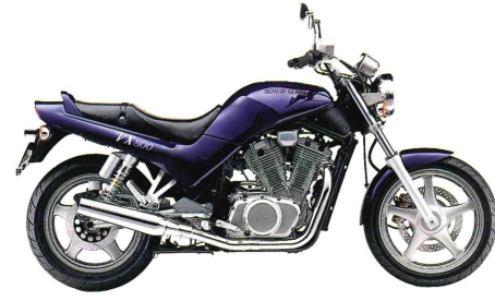
VX 800 2-Zylinder, 4 Takt, 45°-V-Motor, wassergekühlt, 805 cm 3 , 45/37 kW bei 6800/6000 min -1 , OHC, 72,0 Nm bei 5400 min -1 /69,0 Nm bei 2800 min -1 , 4 Ventile, 5 Gänge, 180/170 km/h, Kardan-Antrieb, Sitzhöhe: 785 mm, Tankinhalt (Reserve) 19(3) Liter, Farben: Schwarz, Purple.
