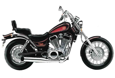
VS 1400 2-Zylinder, 4-Takt, 45°-V-Motor, Luft/Ölgekühlt, 1360 cm 3 , 47 kW bei 4600 min -1 , 113 Nm bei 2600 min -1 , OHC, 3 Ventile, 5 Gänge, 170 km/h, Kardan-Antrieb, vollgetankt 290 kg, Sitzhöhe: 725 mm, Tankinh. (Reserve) 13 (3) Liter, in Deutschland ohne Soziallehne, Farbe: Schwarz, Maroon.
