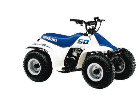
LT 50 1-Zylinder, 2-Takt, luftgekühlt, 49 cm 3 , 1 kW bei 500 min -1 , 2,65 Nm bei 3000 min -1 , Getrenntschmierung, 1 Gang, Sitzhöhe: 470 mm, Leergewicht/Fahrfertig: 48 kg, Tankinhalt 1,5 Liter, Farben: Weiß/Blau. Keine Straßenzulassung.
