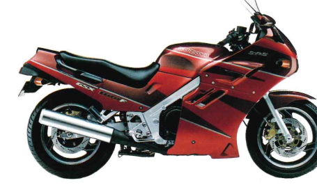
GSX 1100 F 4 Zylinder, 4-Takt, Reihenmotor, Luft/Ölgekühlt, 1128 cm 3 , 74 kW bei 8000 min -1 , 96 Nm bei 6500 min -1 , DOHC, 4 Ventile, 5 Gänge, über 200 km/h, Gewicht vollgetankt 273 kg, Sitzhöhe: 795 mm, Tankinhalt (Reserve) 21 (7) Liter, Höhenverstellbare Scheibe, Farben: Rot, Purple-Silber.
