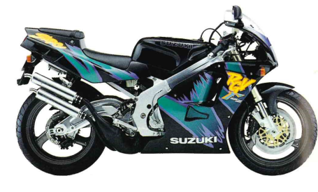
RGV 250 2-Zylinder, 2-Takt 90°-V-Motor, wassergekühlt, 249 cm 3 , 41 kW bei 11000 min -1 , 35,2 Nm bei 11000 min -1 , 6 Gänge, Upside-down-Telegabel, Bananen-Schwinge, unregelmäßiger Katalysator, Einsitzer, 166 kg, Sitzhöhe: 800 mm, Tankinh. (Reserve) 14(3) Liter, Farben: Blau/Weiß, Schwarz.
