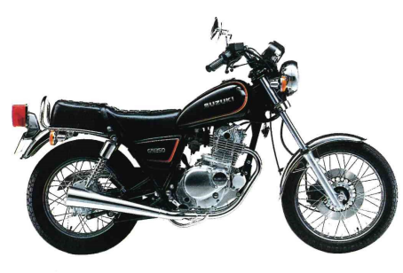
GN 250 1-Zylinder, 4-Takt, luftgekühlt, 249 cm 3 , 13 kW bei 8200 min -1 , 16,5 Nm bei 4000 min -1 , OHC, 4 Ventile, 5 Gänge, 121 km/h, Gewicht vollgetankt 140 kg, zwei Sitzplätze, Sitzhöhe: 740 mm, Tankinhalt (Reserve) 10 (2) Liter, Farbe: Rot, Schwarz.
