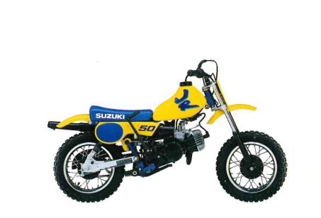
JR 50 1-Zylinder, 2-Takt, Kinder - Bike, 49 cm 3 , 1 kW bei 5000 min -1 , Kickstarter, 1 Gang, Leergewicht/Fahrfertig: 37 kg, Sitzhöhe: 480 mm, Tankinhalt 2 Liter, Farbe: Gelb. Keine Straßenzulassung.
