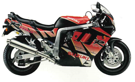
GSX-R 1100 4-Zylinder, 4-Takt, Reihenmotor, Luft/Ölgekühlt, 1128 cm 3 , 74 kW bei 9000 min -1 , 90 Nm bei 7000 min -1 , DOHC, 4 Ventiler, Slingshot-Vergasers, 5 Gänge, über 200 km/h, vollgetankt 248 kg, Sitzhöhe: 820 mm, Tankinhalt (Reserve) 21 (5) Liter, Farben: Weiß/Blau, Schwarz/Rot, Schwarz.
