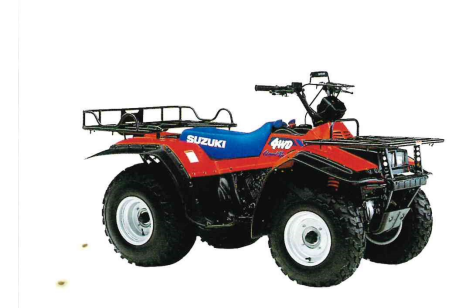
LT-4 WD 1-Zylinder, 4-Takt, 246 cm 3 , 15 kW, 1 kW bei 5000 min -1 , Allrad-Kardan-Antrieb, E-Starter, Sitzhöhe: 755 mm, Leergewicht/Fahrfertig: 244 kg, Tankinhalt 12 Liter, Farbe: Rot. Straßenzulassung auf Anfrage.
