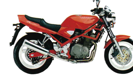
GSF 400 Bandit 4-Zylinder, 4-Takt, Reihenmotor, Nüssigeilgekühlt, 398 cm 3 , 37 kW bei 10600 min -1 , 38 Nm bei 9600 min -1 , Bohrung x Hub: 56,0 x 40,4 mm, 4 Slingshot-Vergasers, 6 Gänge, 170 km/h, vollgetankt 190 kg, Tankinhalt (Reserve) 16 (3) Liter, Sitzhöhe: 790 mm, Farben: Rot, Grün.
