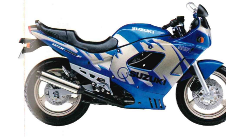
GSX 600 F 4-Zylinder, 4-Takt, Reihenmotor, Luft/Ölgekühlt, 600 cm 3 , 63/37/20 kW bei 11000/8600/6600 min -1 , 58,5/46/35,8 Nm bei 9600/7000/4600 min -1 , DOHC, 6 Gänge, über 200/180/150 km/h, Sitzhöhe: 795 mm, vollgetankt 222 kg, Tankinh. (Res.) 20 (4) Liter, Farbe: Rot, Blau.
