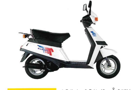
CP 50 1-Zylinder, 2-Takt, 49 cm 3 , 3 kW bei 6000 min -1 , 4,5 Nm bei 5400 min -1 , 50 km/h, unger. Katalysator, Elektro+Kickstarter, Sitzhöhe 750 mm, Leergewicht/Fahrfertig: 75 kg, Tankinhalt/Reserve: 5,5 Liter (Blei frei Normalbenzin), Farbe: Weiß, Schwarz.
