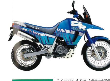
DR 800 BIG 1-Zylinder, 4-Takt, Luft/Ölgekühlt, 779 cm 3 , 37 kW bei 6600 min -1 , 20 kW bei 5600 min -1 , 59 Nm bei 5400 min -1 , 53 Nm bei 2800 min -1 , OHC, 4 Ventile, 5 Gänge, 160 km/h / 130 km/h, vollgetankt 222 kg, Sitzhöhe: 890 mm, Tankinhalt (Reserve) 24 (4) Liter, Farben: Rot, Blau.
