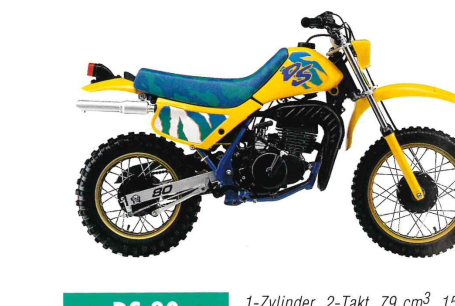
DS 80 1-Zylinder, 2-Takt, 79 cm 3 , 15,5 kW bei 7500 min -1 , 7,3 Nm bei 7000 min -1 , Getrenntschmierung, 5 Gänge, Sitzhöhe: 650 mm, Leergewicht/Fahrfertig: 58 kg, Tankinhalt 4,7 Liter, Farbe: Gelb, Keine Straßenzulassung.
