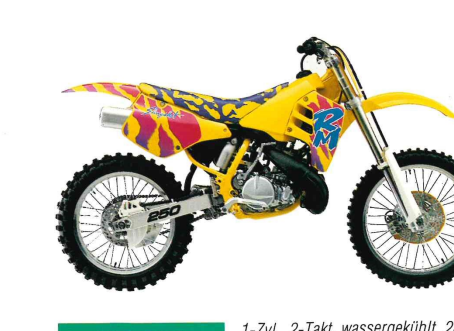
RM 250 1-Zyl., 2-Takt, wassergekühlt, 249 cm 3 , 3,39 kW bei 8000 min -1 , 45,8 Nm bei 7000 min -1 , Bohrung x Hub: 67 x 70,8 mm, 5 Gänge, Tankinhalt 8,5 Liter, Wettbewerbsmodell ohne Straßenzulassung.
