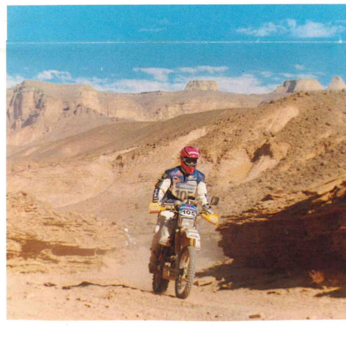
DR 350 S/SH 1-Zylinder, 4-Takt, Luft/Ölgekühlt, 349 cm 3 , 20 kW bei 7600 min -1 , 27 Nm bei 6200 min -1 , OHC, 4 Ventile, 6 Gänge, 130 km/h, vollgetankt 140/144 kg, Sitzhöhe: 900 mm (SUZUKI-High-Contral: 890 mm, 850 mm), Tankinh. (Reserve) 9 (1,5) Liter, Farben: Weiß/Blau, Weiß/Gelb.
