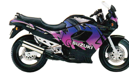
GSX 750 F 4-Zylinder, 4-Takt, Reihenmotor, Luft/Ölgekühlt, 748 cm 3 , 74 kW bei 10400 min -1 , 70,6 Nm bei 9800 min -1 , DOHC, 4 Ventile pro Zyl., 6 Gänge, über 200 km/h, vollgetankt 231 kg, Sitzhöhe: 800 mm, Tankinhalt (Reserve) 20 (5) Liter, Farben: Schwarz, Rot, Silber.
